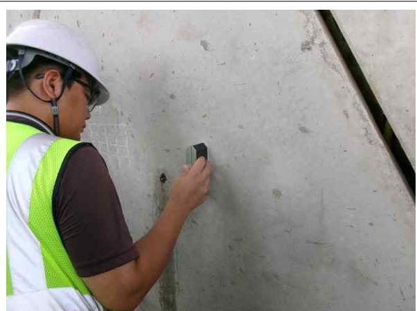
경사계를 이용한 경사도 측정
